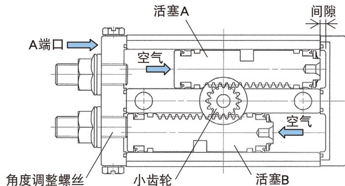
如根据以上说明而明了般, 该现象是于利用产品角度调整螺丝的情形下发生的, 藉由在外部设置止动部等进行角度调整, 以及使活塞与产品的角度调整螺丝不接触, 可防止力矩减半。
