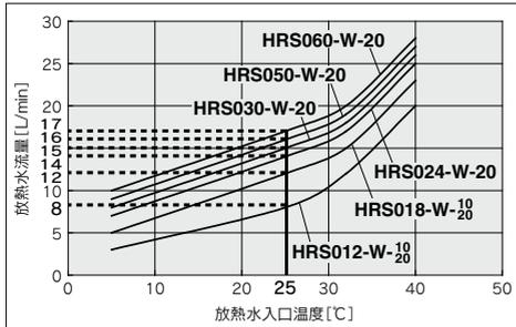
※循環液定格流量、冷却能力に記載された冷却能力時での放熱水量です。
