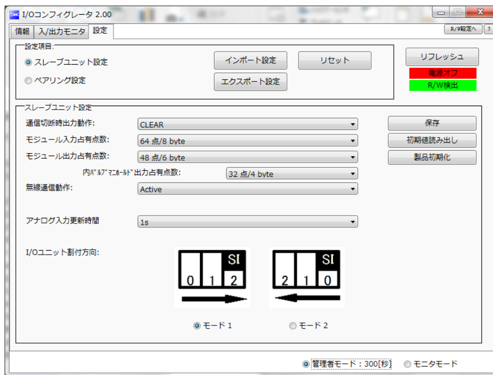
スレーブユニット設定完了後の画面表示 (無線スレーブ①)
