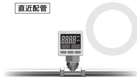
元配管から製品が離れると、延長配管部分の温度変化等の外乱によって正確な計測ができなくなります。また、元配管から遠くなることにより温度の伝達が遅れ応答が遅くなります。
