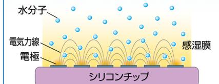
空気中の水分子を吸湿する感湿膜が、水分子を取り込むことで変化する誘電率より、相対湿度を測定。
