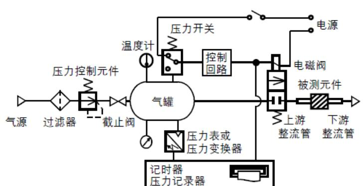
图3. JIS B 8390 的试验回路
