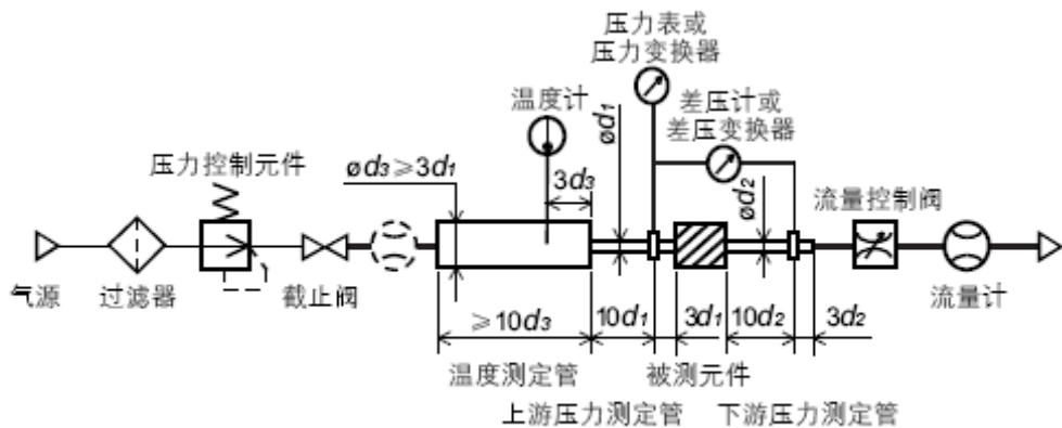
图2. ISO6358、JIS B 8390 的试验回路
