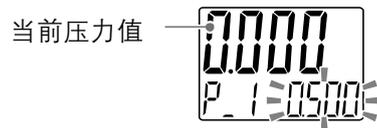
③ 按UP或DOWN键变更设定值后,按SET键进入开关输出的延迟(delay)时间的设定。(可以使用快照功能。)(参考58页)
