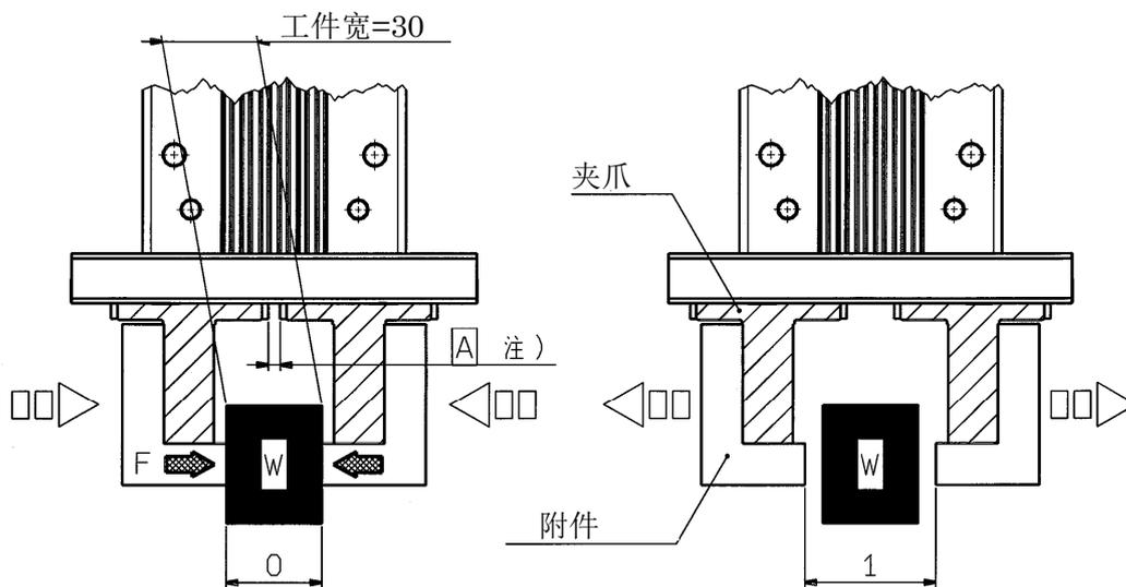
注) 用工件进行原点复位时, 行程(动作范围)就减少  $A$ mm, 请再确认步骤数据的值。
