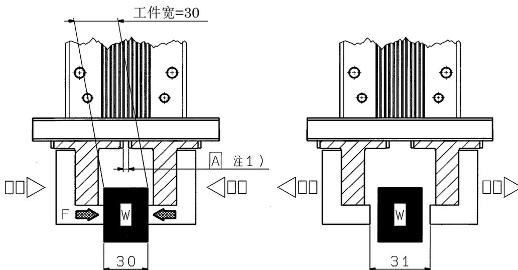
注 1) 用工件进行原点复位, 行程(动作范围)就减少  $A$ mm, 请再确认步骤数据的值。
