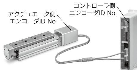
制御電源投入時に、ID Noを確認。ID Noに相違があるとエラーを出力。
