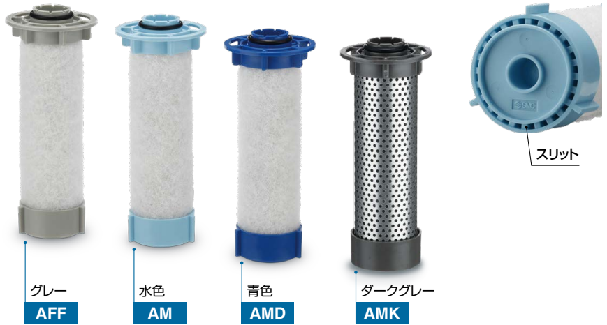
AFF、AM、AMDの3機種でスリット付エンドキャップを採用
