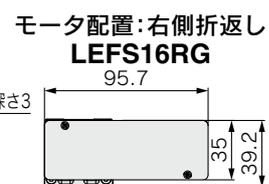
注1) R面取りがあるため本体取付基準面を使用して設置される場合には、相手面もしくはピン高さを2mm以上にしてください。(推奨高さ5mm)
