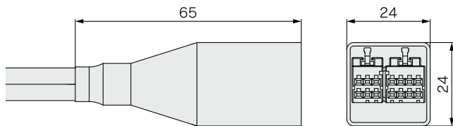
バッテリーレスアブソリュートエンコーダのコネクタカバー寸法
