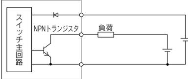
図1 NPN出力タイプの接続例
