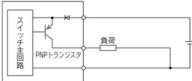
図4 PNP出力タイプの接続例
