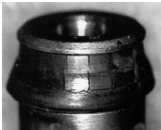
写真2 チェックパッキンの亀裂
